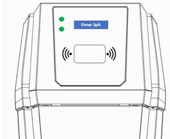
Utilizzando la carta RFID MASTER fornita in confezione, è necessario registrare tutte le carte RFID UTENTE che saranno abilitate alla ricarica. Questa operazione, da svolgere unicamente in fase iniziale o ogni qualvolta un nuovo utente dovrà essere abilitato alla ricarica, si svolge secondo le seguenti operazioni:
