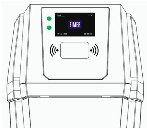
2. Sul display è possibile notare il simbolo di un'antenna che identifica la connessione cellulare. Dopo pochi minuti dall'alimentazione, la stazione risulta regolarmente connessa alla rete cellulare e sul display è possibile trovare la seguente simbologia
