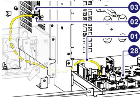
**HINWEIS** – Das Kabel ist zusammen mit den anderen Kabeln der Anschlussbox durch den Boden der Trennwand (Gleich-/Wechselstromseite der Anschlussbox) zu führen.
