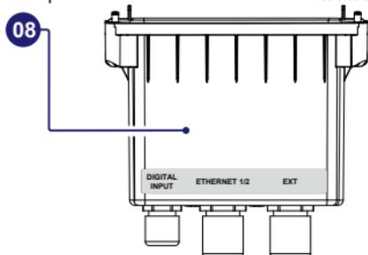
Il PVS-20/30/33-CCB deve essere collegato al connettore USB (10) dell'inverter posto sotto la scatola di cablaggio segnali (08).
