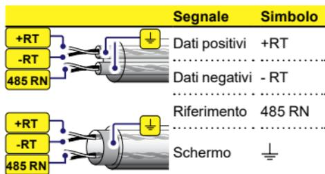
**ATTENZIONE** – Lungo la linea di comunicazione deve essere fornita una continuità di schermatura, che deve essere messa a terra in un singolo punto.
