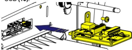
• Serrare la vite fornita per fissare in posizione il PVS-20/30/33-CCB (coppia di serraggio 4 Nm).
